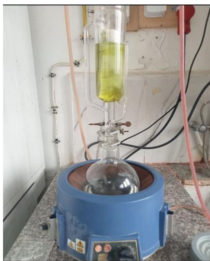
Figure 8: Extraction de la plante par Soxhlet.
